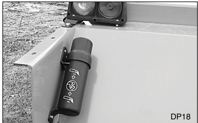
Figura 53. Tubo manual instalado
