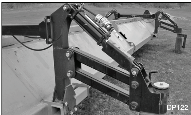
Figura 48. Tubos do pivô, pivôs do rodízio e cilindros instalados
